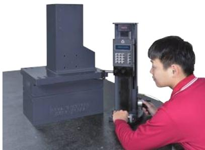
電子量表對主軸座軌道面進行檢驗，使主軸座與機身的垂直度達到幾何精度要求。
