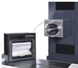
磨輪軸錐面測定前中後三點之偏擺，在精密儀器的監控下維持在標準值以內。
