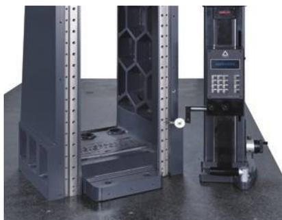
機身置於花崗岩平台上，以精密的電子量表量測軌道垂直度。
